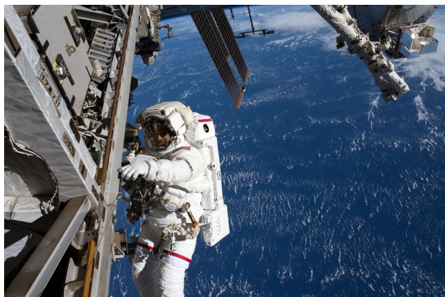
Figur 2. NASA-astronaut Ricky Arnold på EVA vedligeholder udstyr på ISS's store bjælke. Bemærk Canada 2.0-robotarm og ASIM-instrumenterne øverst til højre. Foto: NASA/Andrew Feustel (CC BY-NC-ND 2.0 DEED).
