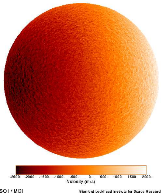
Figur 5. Illustration af en måling af radialhastigheden af Solens overflade med MDI-instrumentet på SOHO-satellitten. Farveskalaen viser hastigheden i satellittens retning. Variationen er domineret af Solens rotation, med en overfladehastighed på ca. 2 km/s ved Solens ækvator. De øvrige variationer skyldes konvektion og den kombinerede effekt af over hundrede tusinde egensvingninger. Ved at analysere sådanne målinger optaget hvert minut over flere måneder kan de enkelte svingninger adskilles, og deres frekvenser bestemmes.
