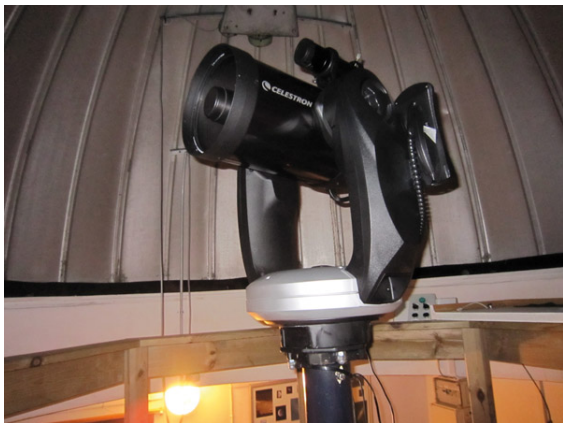
Figur 3. Kikkerten og den solide observationsplatform hviler på et massivt betonfundament. Foto: K.E. Sørensen.
