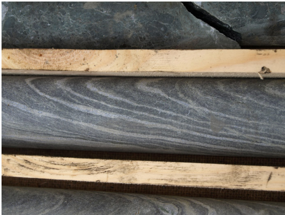
Figur 2. Borekerner med båndet jernmalm som består af vekslende lag af kvarts og magnetit.
