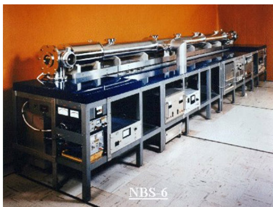
Figur 1. Primær sekundstandard baseret på en stråle af cæsiumatomer. Dette ur var den amerikanske tidsstandard fra 1975 til 1993.
