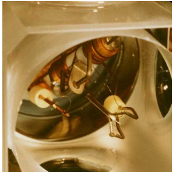
Figur 3. Eksempel på en ionfælde. Det viste eksempel er en sfærisk Paul-fælde der er velegnet til indfangning af enkelte ioner. En sådan fælde kan fastholde den samme ion i op til flere måneder.
