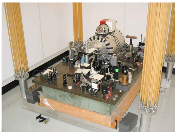
Figur 5. Den ultrastabile laser fra kviksølvionuret i USA. Her er hele kaviteten samt det optiske bord den er monteret på, som har en masse på omkring 500 kg, ophængt fra loftet i 5 meter lange elastikker.
