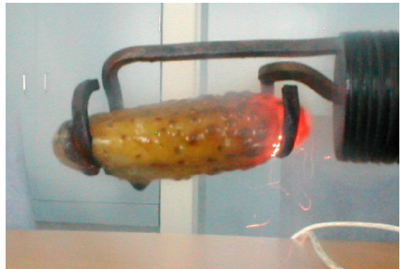
Figur 4. Efter lidt tid begynder agurken at lyse. Farven stammer fra den gule D-linie i natrium. Bemærk at farverne på billedet ikke er gengivet helt korrekt!
