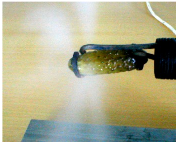
Figur 3. Når der sættes strøm til agurken, begynder denne først at dampe kraftigt.
