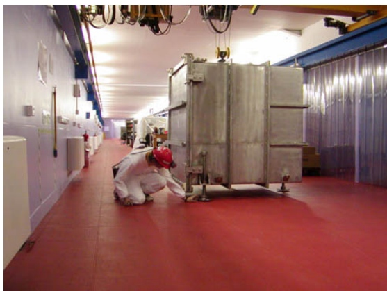
Figur 2. Vakuums-kammeret til mørkt stof-detektoren under installation i Boulby-laboratoriet.
