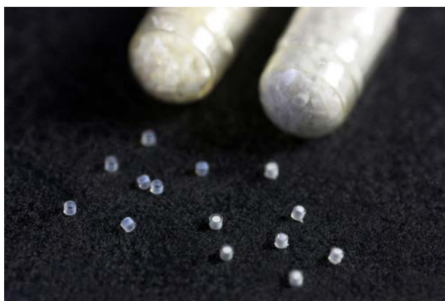
Figur 1. Tomme (venstre) og fyldte (højre) mikrocontainere henholdsvis uden for eller inde i gelatinekapsler til oral dosering. Foto: Jesper Scheel, DTU Sundhedsteknologi.
