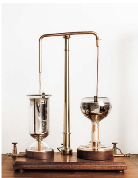
Figur 2. I Steno Museets samling findes der en rekonstruktion af Faradays rotationsapparat fra 1821. Til venstre ses enden af en magnet, hvis ene pol er fæstnet til bunden af et glas med kviksølv, mens den anden pol kan bevæge sig frit omkring ledningen. Til højre er det ledningen, der kan bevæge sig omkring en fast monteret magnet. Rotationsapparatet var verdens første elektromotor. Foto: Lise Balsby, AU Foto.
