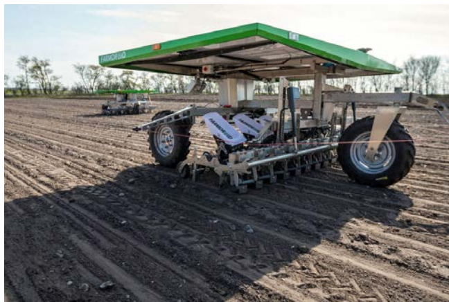
Figur 1. Markrobotten FarmDroid FD20 vejer 900 kg og har en kapacitet på 20 ha. Tophastigheden er omkring 1 km/t.
