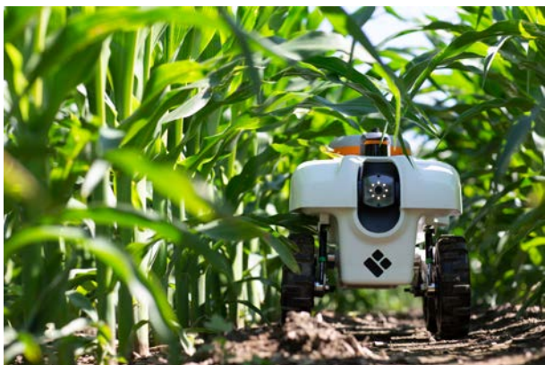
Figur 5. TerraSentia-robotten bruger maskinlæring til at identificere planternes egenskaber, såsom deres højde, bredde og bladareal.
