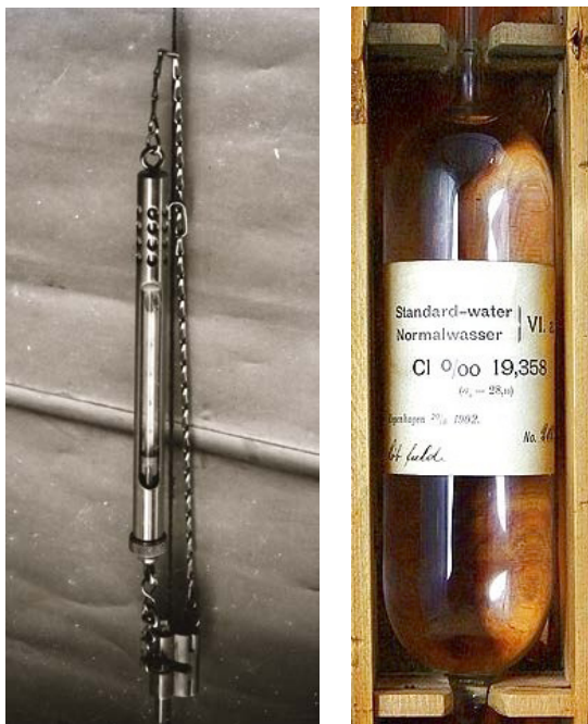
Figur 7. Knudsens vendetermometer og ampul med “Standard Seawater”.
