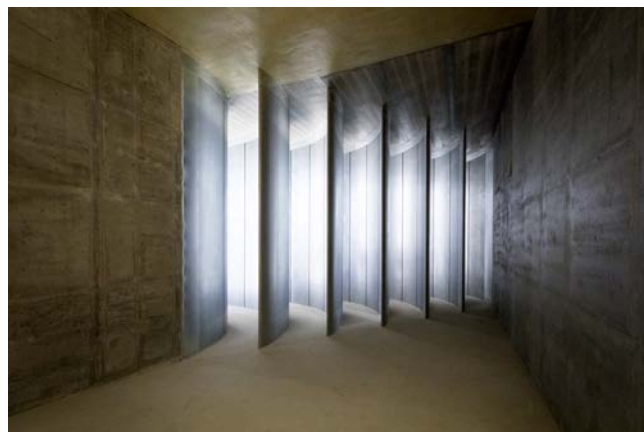
Figur 2. I hvert hjørne af vindtunnelen er der ledeskovle, der hjælper med at dreje strømmingen om hjørnerne.
