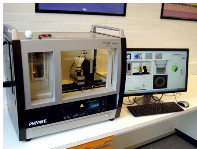
Figur 1. Et af Nanotekets røntgenapparater sat op til CT-skanning af fjerbold. Røntgenrøret sidder til venstre, og man aner katoden gløde orange. Bolden roteres, og man optager fx 200 projektioner fra forskellige vinkler. Disse behandles i computeren, og en 3D-rekonstruktion dannes.
