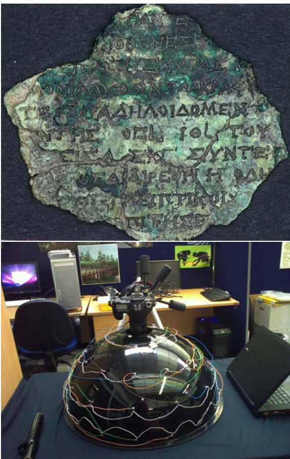
Figur 6. Øverst: Et eksempel på PTM af Mekanismen, hvor man tydeligt kan se inskriptionerne. Nederst: Opstilling, hvor kameraet er øverst på kuplen, og ledningerne mellem de små blitz sidder rundt om på kuplen.
