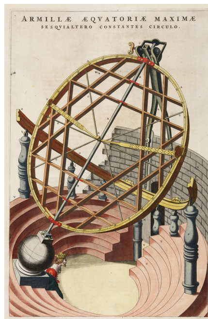
Figur 14. Den store armille i Stjerneborg. Dens skala i messing har en radius på 136 cm hvorved 1' = 0,40 mm og instrumentet anvendes til måling af deklinationer.
