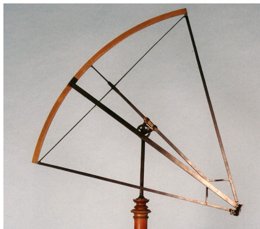
Figur 10. Bürgi sekstant. Sekstant efter 1604 nu i Prag, muligvis fremstillet af Jost Bürgi. Radius er 1145 mm. Til transport eller opstilling på et bord eller en mur ved observationer kan sekstanten tages af stativet. Bürgi udvikler i 1582 en sådan sekstant med radius 1,1 m! Den kan betjenes af kun en observatør, mens Tychos store træsekstant (figur 12) kræver to observatører. Sekstanten er helt i metal, og viserstaven med spaltevisir føres via et drivtandhjul langs målebuen (limbus). Dette visir rettes mod den ene af de to stjerner man ønsker at måle vinkelen imellem, idet sekstanten drejes om de to akser, der ses i midten, og om en lodret akse. Et andet visir til den anden stjerne har formodentlig siddet på den ene ende af målebuen.
