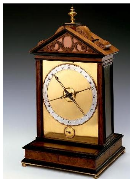
Figur 8. Observatoriumsur med krydsflagshæmning, automatiseret optræk og savtandsur svarende til Kassel observatoriets sekundur fra 1585. Fremstillet af Jost Bürgi i Prag 1625. Fra [12].
