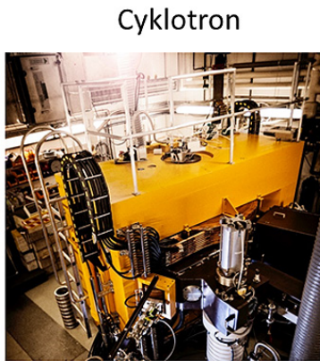
Figur 5. En PET-scanning er en tretrinsskridt. Først skal nuklidet produceres i cyklotronen (t.v.), så skal det bygges ind i et relevant sporstof (midten), og efter injektion i patienten er man klar til scanning (t.h.).
