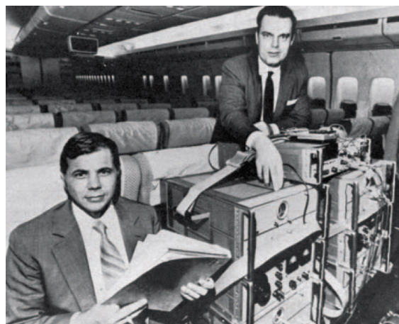
Figur 6. Amerikanerne Hafele og Keating sendte i oktober 1971 atomure rundt om Jorden med almindelige rutefly, både vestpå og østpå. De sammenlignede dem med identiske ure, der ikke havde bevæget sig i forhold til Jorden. Det viste sig, at de rejsende ure pga. bevægelsen havde tabt godt hundrede milliarddele sekunder i forhold til de ure, der ikke havde flyttet sig. Resultatet var i god overensstemmelse med relativitetsteorien. Foto: AP.
