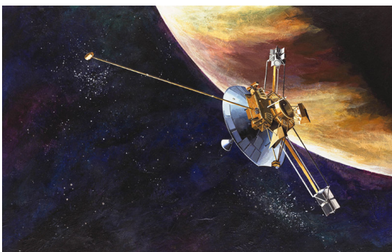
Figur 3. Tegning af Pioneer 10 foran Jupiter. Bemærk strømgeneratoren for enden af den arm, som peger mod Jupiter (NASA).
