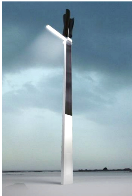
Figur 6. "CopenHybrid" er en sol- og vinddrevet LED-gadelampe, der konceptuelt er udviklet til, at kunne levere nok lys hele året, når den er anvendt på en dansk E2-vejklasse. Gadelampen er omkring 7,5 m høj.
