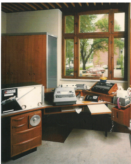
Figur 5. Et GIER anlæg praktisk taget taget magen til Observatoriets 1964 maskine. Det ses, at opstillingen er næsten som i det gamle anlæg. Strimmellæseren er nu den stærkt forbedrede RC2000 og designet er af væsentlig højere kvalitet end før. Fra [2].
