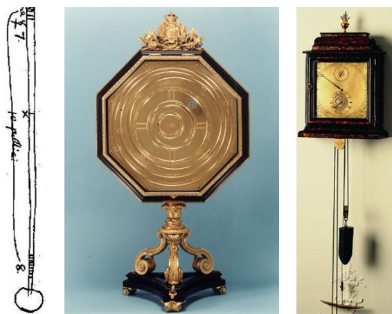
Figur 6. Til venstre en skitse af Rømers termometer fra hans notesbog "Adversaria". I midten planetmaskinen som blev foræret til kong Christian V. Til højre det eneste eksisterende af Rømers pendulure, som hænger på Kroppedal Museum, hvor også planetmaskinen findes i kopi.
