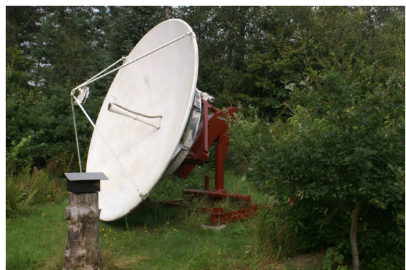
Figur 8. Observatoriet har et endnu ikke driftklart 3.76m radioteleskop, som er doneret af TDC. Foto: Michael Quaaade.
