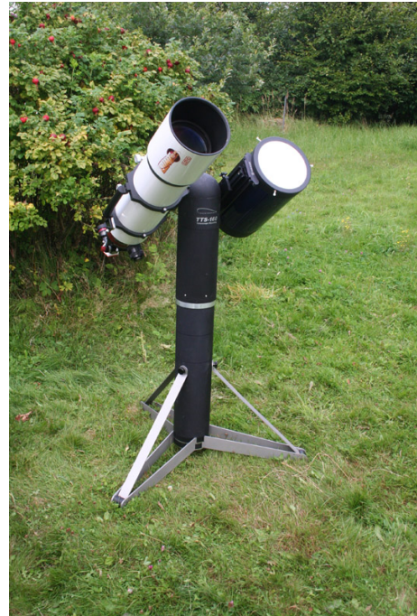
Figur 7. Observatoriets dobbelte solkikkert. Den hvide Lunt LS152HA med H_{\alpha} filter og den blå Meade SCT med Mylar filter side om side på Track the Stars TTS-160 monteringen. Foto: Niels Haagh.
