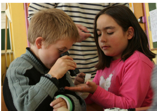
Figur 4. Et mikroskop er blevet lavet ud fra to okularer. Opløsningsevnen er ca. 20 μm.
