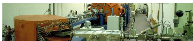
Figur 3. Acceleratoren til 14 C-målinger på Aarhus Universitet.
